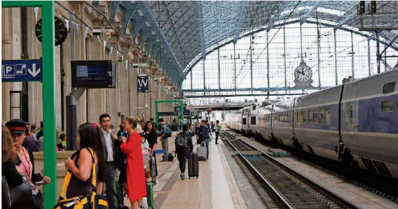
Schnelle Reise. Bahnhof Bordeaux-St-Jean. Die zwei gekuppelten TGV nach Lille/Strassburg mit Zwischenhalten werden bis an den Südrand von Paris einem Nonstop-Doppelstock-TGV folgen. Beide Züge erreichen 320 km/h. Foto J. Bosshard
